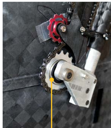
Der CSK Freilauf von Stieber sitzt auf den Naben des Vorderrads und sorgt für den Antrieb der Räder mit Geschwindigkeiten bis zu 145km/h.
