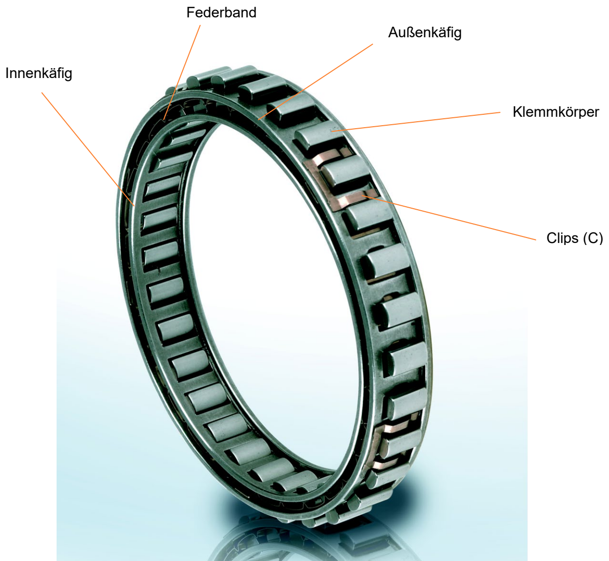
Abb.2 Aufbau DC Käfig
