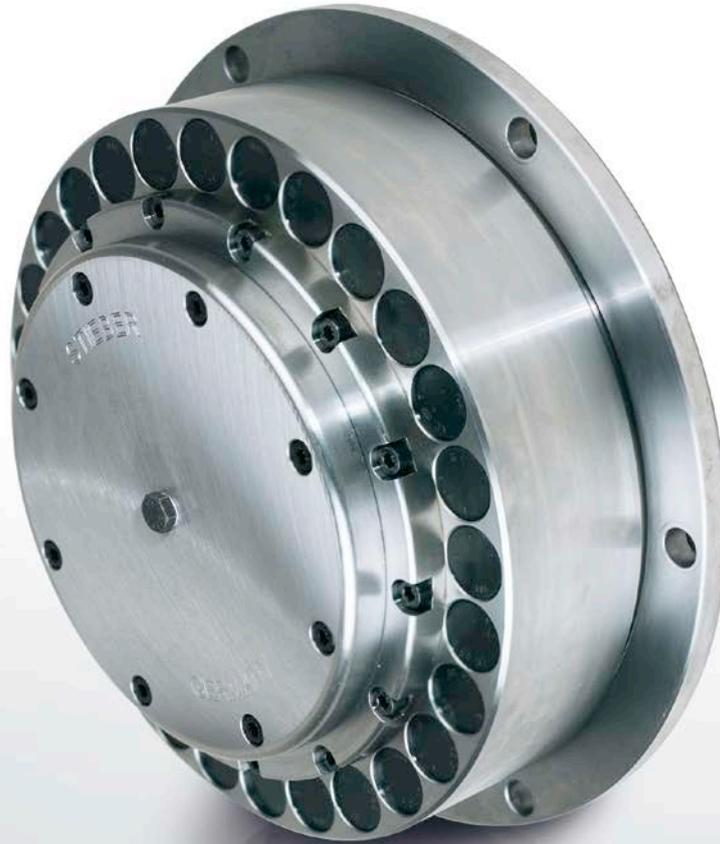
Bei den Bauarten RSRV und RSRT handelt es sich um fliehkraftabhebende RSCI – Klemmkörperfreiläufe (» siehe Seiten 74 bis 77), die zusätzlich mit einer kraftschlüssigen Drehmomentbegrenzung ausgestattet sind. Diese begrenzt das übertragene Drehmoment auf einen Maximalwert, der werkseitig eingestellt wird. Die Verwendung von speziellen, ölgetränkten Reibbelägen gewährleistet eine gleichbleibende Drehmomentgrenze, auch nach langer Stillstandzeit.
