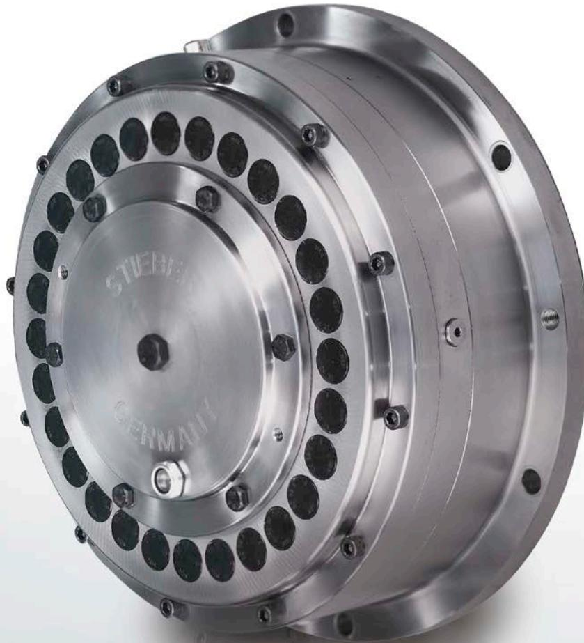
Die Bauart RDBK basiert auf dem fliehkraftabhebenden Freilauf RSCI (siehe Seite 74 bis 77), welcher zusätzlich mit einer kraftschlüssigen Drehmomentbegrenzung ausgestattet ist. Das maximal zu übertragende Drehmoment wird werksseitig nach Kundenwunsch eingestellt.
